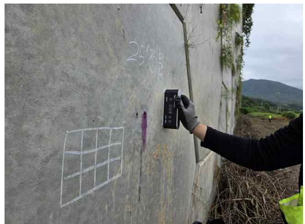
경사계를 이용한 경사도 측정
